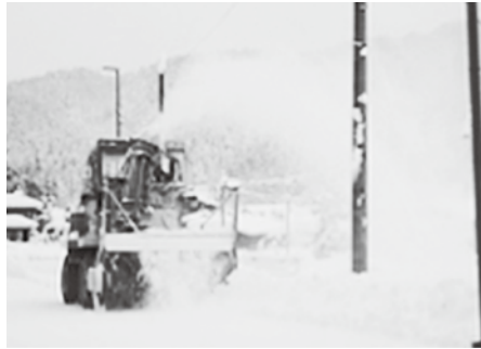
ロータリー除雪車で道路除雪
