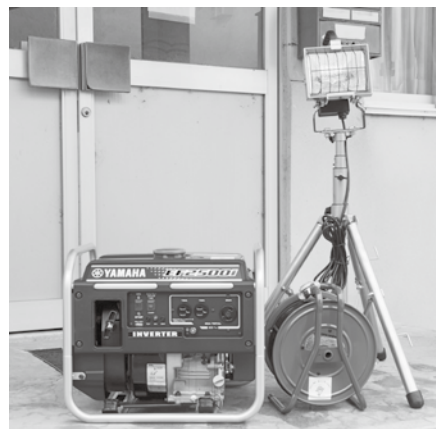
▲非常用発電機と投光機
