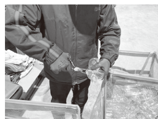
ラベルが残った乳酸菌飲料ペットボトル(左写真) 作業者によるラベル除去(右写真)
