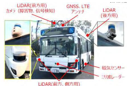
図 5-1 中型自動運転バスの実証実験を行う地域、使用車両
