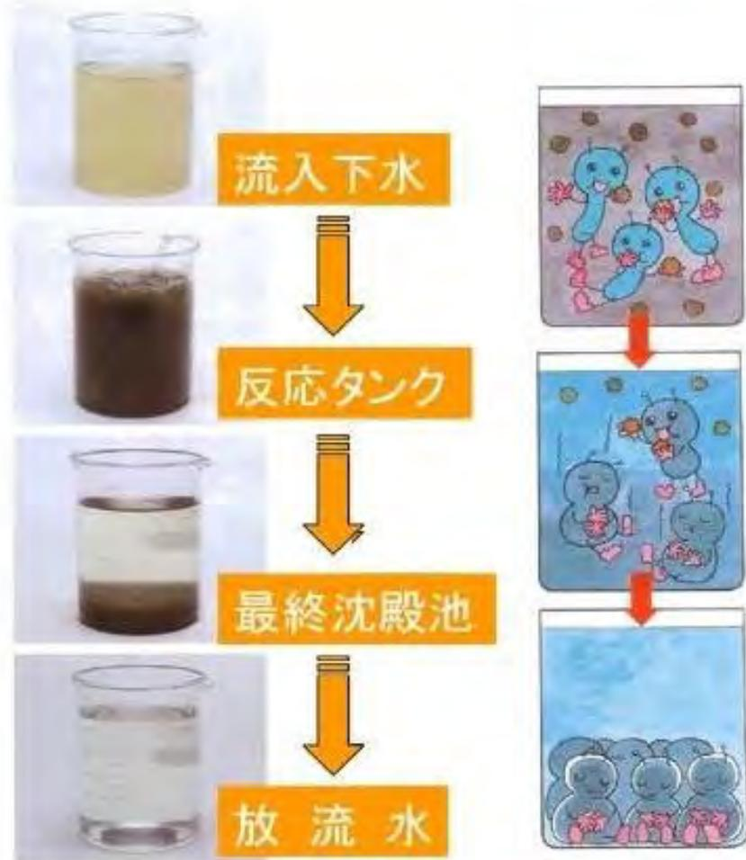
下水の中に微生物を混ぜて空気を吹き込むと、微生物は元気になり下水の汚れを食べ始める。
