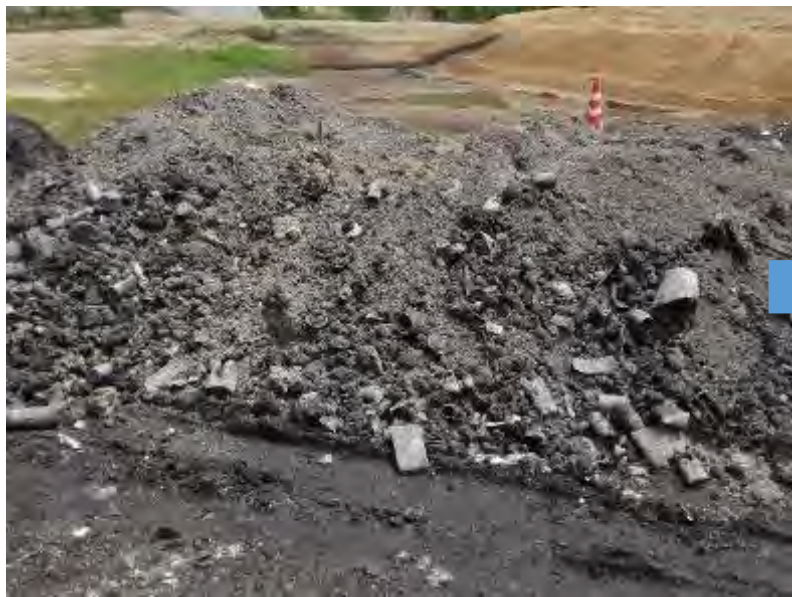
焼却残渣（焼却灰）
