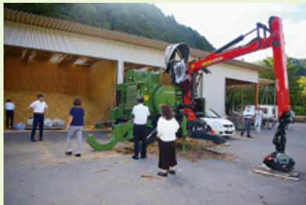
バイオマス発電用に導入した中型チップパー
