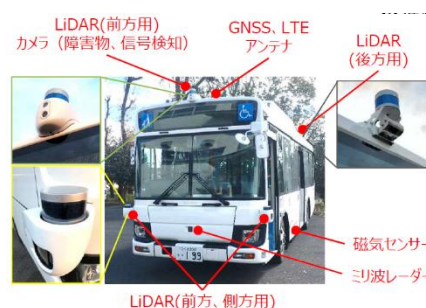
図 5-1 中型自動運転バスの実証実験を行う地域、使用車両
