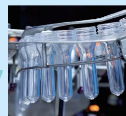
プリフォームを熱してボトル用の金型に入れ、高圧空気を注入して膨らませます
